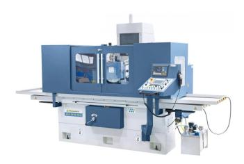
Diese Modelle eignen sich für die Bearbeitung von Werkstücken bis 700 kg und einer Schleiffläche bis 1150 x 560 mm. Durch die umfangreiche Serienausstattung wie z.B.: Computergesteuerte Vertikal- zustellung, Parallelabziehvorrichtung mit Mikrometerverstellung, Magnetplatte mit Entmagnetisierungseinrichtung sowie der 2-Achs-Digitalanzeige bieten diese Modelle ein optimales Leistungspaket für den Anwender.
