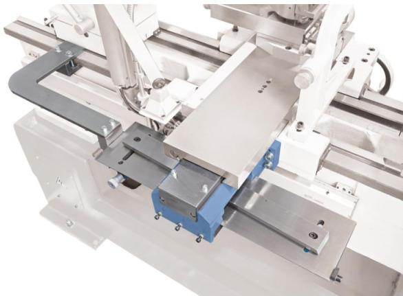
Die Kegeldreheinrichtung ist zur nachträglichen Montage an den Maschinen Solid 460 x 1000, Solid 460 x 1500, Solid 460 x 1000 Vario und Solid 460 x 1500 Vario geeignet.
