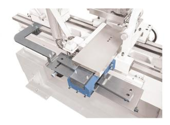
Die Kegeldreheinrichtung ist zur nachträglichen Montage an den Maschinen Smart 410 x 1000, Smart 410 x 1500, Smart 410 x 1000 Vario und Smart 410 x 1500 Vario geeignet.
