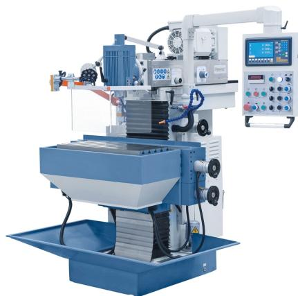
Die Werkzeugfräsmaschine WFM 850 Servo ist für die Bearbeitung von Werkstückgewichten bis 200 kg ausgelegt. Durch die stabile und schwere Graugusskonstruktion und der hohen Steifigkeit der Maschinenbaugruppen erfüllt dieses Modell die besten Voraussetzungen für genaues Arbeiten. Hauptmerkmale dieser Maschine ist der Servoantrieb mit elektronischen Handrädern in allen Achsen sowie die stufenlose Drehzahlregelung.
