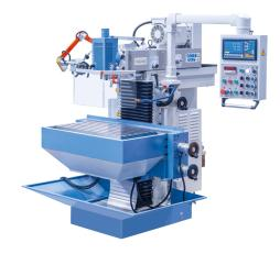
Die Werkzeugfräsmaschine WFM 800 Servo ist für die Bearbeitung von Werkstückgewichten bis 200 kg ausgelegt. Durch die stabile und schwere Graugusskonstruktion und der hohen Steifigkeit der Maschinenbaugruppen erfüllt dieses Modell die besten Voraussetzungen für genaues Arbeiten. Hauptmerkmale dieser Maschine ist der Servoantrieb mit elektronischen Handrädern in allen Achsen sowie die stufenlose Drehzahlregelung.
