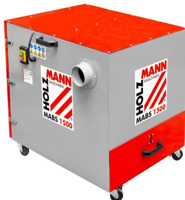
Die Holzmann MABS1500\_400V Absauganlage für Metall ist ideal für den Einsatz in der Metallverarbeitung. Sie bietet eine einfache Filterwechsel, einen großen Auffangbehälter mit Schublade und ist inklusive Staubsack. Zwei Anschlüsse ermöglichen den Betrieb von mehreren Maschinen. Die kompakten Bauform und Räder ermöglichen einen schnellen Ortswechsel.
