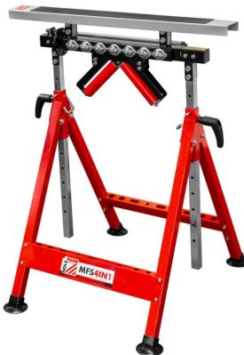
Der Holzmann MFS4IN1 Multifunktionsständer ist ein höhenverstellbares Gerät, das 4 Funktionen in einem bietet. Es verfügt über eine klappbockauflage mit bis zu 200kg Tragkraft, eine rollbockauflage mit bis zu 100kg Tragkraft, eine kugelaufage mit bis zu 100kg Tragkraft und eine V-Unterstützung mit bis zu 50kg Tragkraft.
