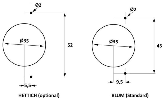
HETTICH-Wechselkopf für BBM35MAN und BBM35PNEU
