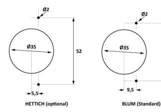
HETTICH-Wechselkopf für BBM35MAN und BBM35PNEU
