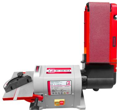
Die Holzmann BT150-914\_230V Band-Tellerschleifmaschine ist ideal für das Schleifen von Längs- und Stirnkanten, Rundungen, Gehrungen und rechtwinkeligen Planflächen. Der schwenkbare Alutisch und das Schleifbandaggregat können von 0°-90° horizontal und vertikal geschwenkt werden. Die konstante Bandgeschwindigkeit und Laufruhe garantieren präzise Ergebnisse.
