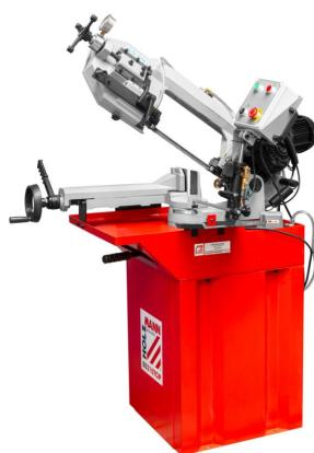
Die Holzmann BS210TOP\_230V Metallbandsäge ist eine präzise Metallbandsäge in schwerer Gussausführung. Sie verfügt über einen Getriebeantrieb und kann für Gehrungsschnitte bis 60° geschwenkt werden. Die kugelgelagerte 5-Punkt Sägebebandführung mit Schnellverstellung und automatischer Endabschaltung ermöglicht eine einfache Handhabung. Der robuste Schraubstock aus Grauguss mit Exzenterspannungsysten und Werkstückkanschlag gewährleistet eine sichere Verbindung.
