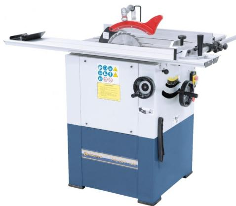
Die Präzisionskreissäge PKS 250 P überzeugt durch zahlreiche technische Innovationen, wie z.B.: Formatschiebetal 1300 mm, Längsanschlag mit Feineinstellung, Sägeblattschwenkung an der Vorderseite usw., welche bei Maschinen dieser Größe unüblich sind. Ihren Einsatzbereich findet dieses Modell vorwiegend beim Bastler, Heimwerker sowie in kleineren Betrieben.
