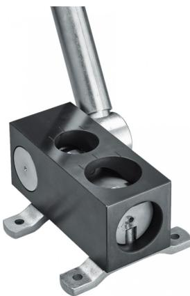
Der Bernardo RAB Rohrausklinker ist ein Gerät zum Ausklinken von Dampf-, Edelstahl-, Gas-, NE- und anderen Rohren bis 3 mm Wandstärke. Es ermöglicht auch das Zusammensetzen und Verschweißen von Rohren im 90° Winkel. Durch die Kombination verschiedener Rohrdurchmesser in einem Gerät wird eine hohe Produktivität bei geringer Investition erreicht.
