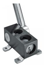
Der Bernardo RAB Rohrausklinker ist ein Gerät zum Ausklinken von Dampf-, Edelstahl-, Gas-, NE- und anderen Rohren bis 3 mm Wandstärke. Es ermöglicht auch das Zusammensetzen und Verschweißen von Rohren im 90° Winkel. Durch die Kombination verschiedener Rohrdurchmesser in einem Gerät wird eine hohe Produktivität bei geringer Investition erreicht.
