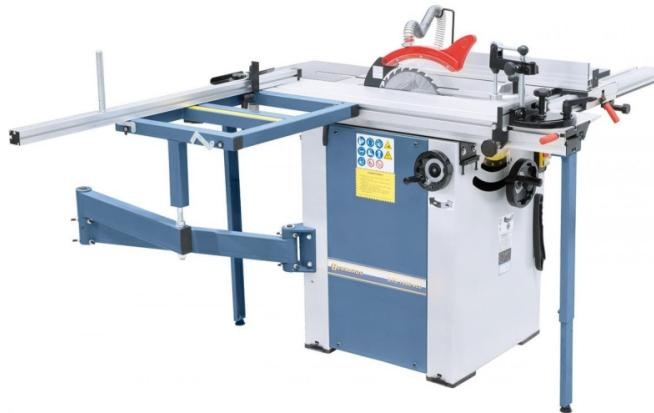
Die Formatkreissäge STS ist je nach Anwendung wahlweise mit zwei verschiedenen Tischlängen lieferbar (1300 / 1600 mm). Serienmäßig ausgestattet mit einem 2,2 kW Motor und einem Sägeblatt mit 254 mm Durchmesser für Schnitthöhen bis 80 mm. Ihren Einsatzbereich findet dieses Modell vorwiegend beim Heimwerker sowie in kleineren Betrieben als Zweitmaschine.
