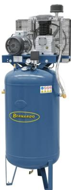
Der Bernardo AC35/VER/270/600/D ist ein Vertikaler Kompressor mit einer Ansaugleistung von 600 l/min und einem Behältervolumen von 270 l. Die Füllleistung beträgt ca. 460 l/min. Der Kompressor hat eine Drehzahl von 1450 U/min und eine Motorleistung von 4,0 kW (5,5 PS). Die Maschinenabmessung beträgt 730 x 600 x 1930 mm und das Gewicht ca. 140 kg.
