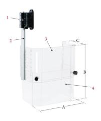
Die Bernardo Schutzeinrichtung PTR-C, Gr. 2 ist eine Schutzeinrichtung für Bohrmaschinen. Sie schützt den Bediener vor direktem Kontakt mit rotierenden Teilen der Spindel und vor wegfliegenden Spänen sowie Kühlmittelspritzern.
