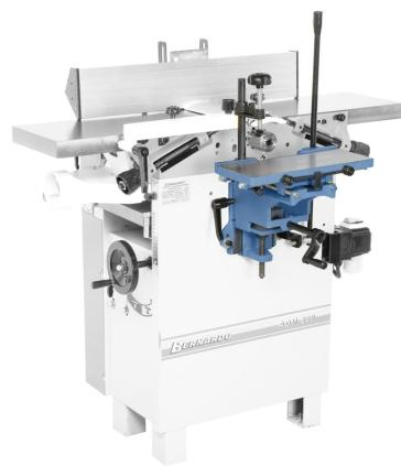
Die Bernardo Langlochbohreinrichtung ADH 250 P / AD 260 / ADM 260 / PT 310 Langlochbohreinrichtungen ist eine professionelle Lösung für präzise Bohrarbeiten. Die Bohreinrichtung verfügt über eine Bohrtischgröße von 370 x 150 mm und ein Westcottfutter mit einem Durchmesser von 0 - 16 mm. Die maximale Bohrtiefe beträgt 105 mm und die Bohrbreite 140 mm. Darüber hinaus ermöglicht die Höhenverstellung eine Anpassung um 85 mm.
