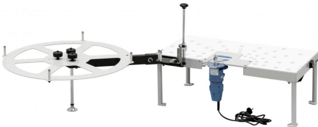
Der Bernardo Stationärartisch ST 95A mit Auflageteller und Kappgerät Zubehör Kantenanleimmaschinen ist serienmäßig mit Auflageteller und Kappgerät ausgestattet. Dies gewährleistet ein genaues Arbeiten bei kleinen, dünnen oder geformten Werkstücken. Die einfache Bedienung der angebauten Maschinen erfolgt durch integrierte Steckdose und Ein-Aus-Schalter.
