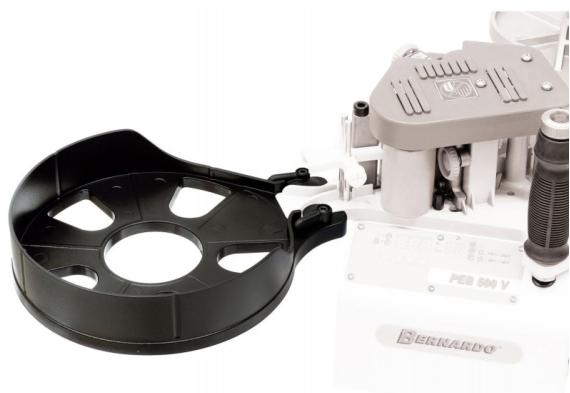
Das Bernardo Kantenmagazin BC 25 Zubehör Kantenanleimmaschinen dient für die saubere Zufuhr des benötigten Kantenmaterials. Es verhindert mögliche Schäden im Vergleich zu hängenden Kantenmaterial. Das Kantenmagazin ist einsetzbar für Kantenmaterial mit einer Höhe von 10 - 62 mm und einer Dicke von 0,4 - 3,0 mm.
