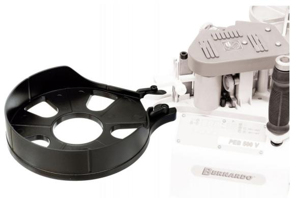
Das Bernardo Kantenmagazin BC 25 Zubehör Kantenanleimmaschinen dient für die saubere Zufuhr des benötigten Kantenmaterials. Es verhindert mögliche Schäden im Vergleich zu hängenden Kantenmaterial. Das Kantenmagazin ist einsetzbar für Kantenmaterial mit einer Höhe von 10 - 62 mm und einer Dicke von 0,4 - 3,0 mm.
