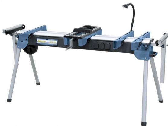
Das Bernardo KSU 1560 Universal-Untergestelle ist ein vielseitiges und robustes Gestell für den Einsatz mit verschiedenen Maschinen wie Tischkreissägen, Kappsägen und Schleifmaschinen. Es bietet eine stufenlos auszieh- und höhenverstellbare Rollenauflage beidseitig und eine kompakte Transportabmessung durch seine zusammenklappbare Bauweise.
