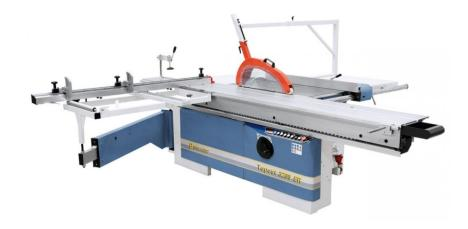
Die Präzisions-Formatkreissäge Topcut 3200 ER ist für den professionellen Anwender bestens geeignet. Der verwindungssteife Maschinenkörper aus einer Stahl-Graugusskombination sowie das stabile Sägeaggregat mit dem starken Antriebsmotor gewährleisten einen vibrationsfreien Lauf und einer elektronischen Schnittgeschwindigkeit. Zusätzlich ist dieses Modell mit einer elektronischen Sägeblatthöhenverstellung sowie einer digitalen Schnitthöhenanzeige ausgestattet.
