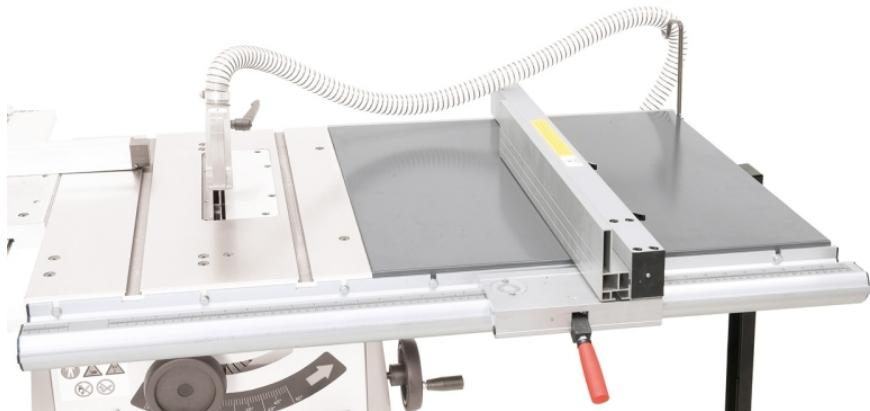
Die Tischverbreiterung ist passend für TK 250 PRO und bietet eine Tischabmessung von 600 x 670 mm.
