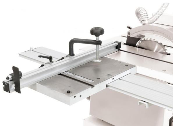
Der Rolltisch ist passend für TK 250 PRO und bietet eine Tischabmessung von 400 x 250 mm sowie einen Verfahrweg von 920 mm.
