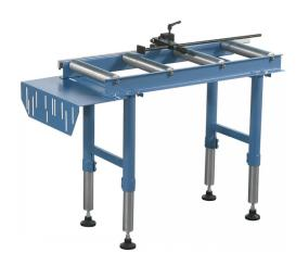
Die Bernardo RB 1000 A Rollenbahnen mit Längenanschlag sind ideal für den Einsatz in verschiedenen Branchen. Die Rollenbahnen bieten eine Bahnlänge von 1000 mm, eine Rollenbreite von 360 mm und einen Rollendurchmesser von 60 mm. Die Höhenverstellung ermöglicht eine Anpassung von 620 bis 1055 mm. Die Belastbarkeit beträgt maximal 500 kg. Das Standrohr hat einen Durchmesser von 50 mm und das Gewicht beträgt etwa 42 kg.
