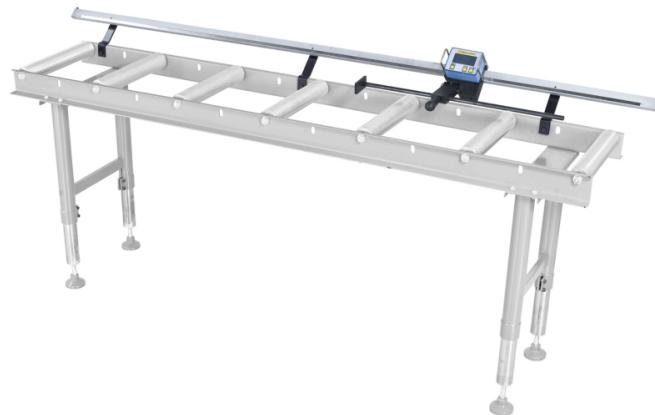
Das Bernardo LS 2 für RB 7 - 2000 Längenmesssystem ist ein präzises Messgerät, das ideal zum Anbau an verschiedenste Rollenbahnen geeignet ist. Es ermöglicht ein einfaches und genaues Ablesen mittels digitaler LCD-Anzeige mit einer Genauigkeit von +/- 0,1 mm/m.
