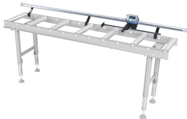
Das Bernardo LS 1 für RB 4 - 1000 Längenmesssystem ist ideal geeignet zum Anbau an verschiedenste Rollenbahnen. Es ermöglicht einfaches und genaues Ablesen mittels digitaler LCD-Anzeige mit einer Genauigkeit von +/- 0,1 mm/m.
