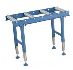
Die Rollenbahn RB 4 ist ein besonders praktisches Hilfsmittel für die Auflage und die Bewegung von langen und schweren Werkstücken. Sie ist individuell einsetzbar und beliebig erweiterbar und durch die nachrüstbaren PVC-beschichteten Rollen auch für heikle Materialien verwendbar.
