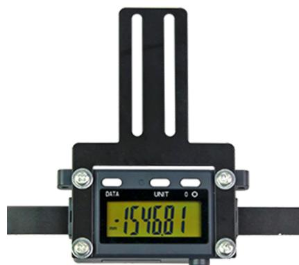
Das digitale Messlineal DML3000 kann auf eine Vielzahl an Holz- oder Metallbearbeitungsmaschinen installiert werden. Das Arbeiten an Fräsmaschinen, Tischkreissägen, Hobelmaschinen etc. wird dadurch noch einfacher. Die digitale Anzeige ermöglicht genaue Messergebnisse und wiederholbare Einstellungen. Der flexible Magnetstreifen hat eine Länge von 3000 mm und kann beliebig gekürzt werden.
