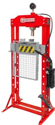
Die Holzmann WP20PLUS Werkstattpresse 20 Tonnen ist der ideale Werkstättenhelfer für Reparatur- und Montagearbeiten. Sie ist geeignet zum Pressen, Ausrichten und Biegen und verfügt über einen robusten einstufigen Hydraulikzylinder sowie einen automatischen Kolbenrückzug. Der Auflagetisch ist höhenverstellbar und die Pressdruck kann bis zu 20 t betragen.
