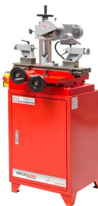
Die Holzmann UWS320\_400V Universal Werkzeugschleifmaschine ist universell einsetzbar zum Schleifen von Bohrern, Fräsern, Drehmeißeln usw. Der sehr robuste und schwingungsfreie Aufbau gewährleistet beste Schleifergebnisse. Das Untergestell mit Werkzeugfach ist serienmäßig enthalten. Große Handräder ermöglichen ein leichtgängiges und präzises Ein- bzw. Zustellen.
