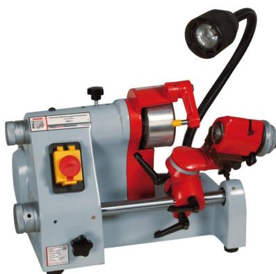
Die Holzmann UWS3\_230V Universal Werkzeugschärfmaschine ist universell einsetzbar durch vielseitige Schwenk- und Einstellmöglichkeiten. Sie eignet sich zum Schleifen von Stempel, Spiralbohrer, Elektroden, Drehmeißel, Zentrierspitzen usw. und bietet hohe Präzision durch robusten Maschinenkörper und vibrationsfrei angetriebene Präzisionsschleifspindel.
