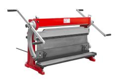
Die Holzmann UBM760 ist eine stabile Multifunktionsmaschine zum Schneiden, Rundbiegen und Abkanten. Sie bietet einen komfortablen 2-Griff-Bedienungshebel und verschiedene breite Abkantelemente für unterschiedliche Werkstückgrößen. Die Maschine verfügt über eine automatische Klemmvorrichtung bei Schneideoperation und ist die ideale Werkstattergänzung bei geringem Platzbedarf.
