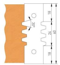
HW-Wendeplatten-Trapez-Verleimfräser Anwendung: Für selbsthemmende Verleimverbindungen in Hart- und Weichholz. Für Tischfräsen mit Handvorschub geeignet. Ausführung: Grundkörper aus Stahl oder hochwerttiger Aluminium-Legierung, ausgerüstet mit zwei HWProfilwendeplatten, doppelseitig profiliert, nur umfangsschneidend, formschlüssig, spandickenbegrenzt, rücksschlagarm. 0
