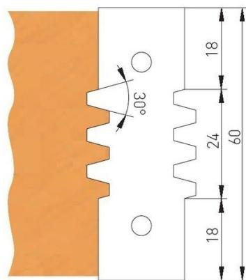
Der Holzmann TVF130Z2/3Z Trapezverleimfräser 3 Zahn ist für selbsthemmende Verleimverbindungen in Hart- und Weichholz geeignet. Er eignet sich für Tischfräsen mit Handvorschub.
