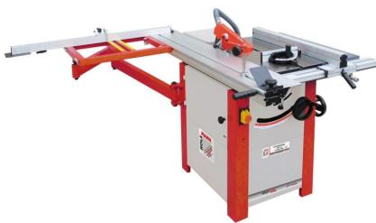
Die Holzmann TS250F1600\_230V Formatkreissäge ist eine professionelle Säge für die Holzbearbeitung. Sie verfügt über ein schwenkbares und höhenverstellbares Kreissägeblatt, einen Graugusstisch mit Tischverlängerung und einer Unterstützungsrolle am Ausleger. Der 1600mm lange Profi-Aluminium-Formatschiebetisch ermöglicht präzise Schnitte.
