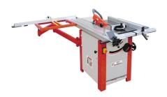
Die Holzmann TS250F1600\_230V Formatkreissäge ist eine professionelle Säge für die Holzbearbeitung. Sie verfügt über ein schwenkbares und höhenverstellbares Kreissägeblatt, einen Graugusstisch mit Tischverlängerung und einer Unterstützungsrolle am Ausleger. Der 1600mm lange Profi-Aluminium-Formatschiebetisch ermöglicht präzise Schnitte.
