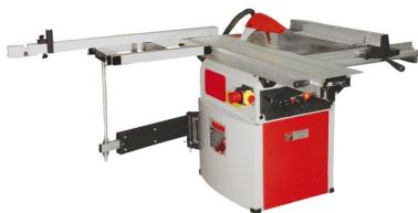
Die Holzmann TS250F\_230V Formatkreissäge ist eine robuste und präzise Ausführung mit Profi-Aluminiumformatschiebeschlitten. Der große und schwenkarmgestützte Ausleger am Schiebetisch ermöglicht eine leichtgängige und präzise Sägeblathöhen- und -winkelverstellung. Die Säge ist bis zu 45° (links/rechts) schwenkbar und hat einen ausziehbaren Gehrungsanschlag mit einem umklappbaren Klappanschlag.
