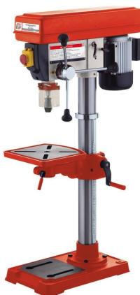
Die Holzmann SB4116HM\_400V Ständerbohrmaschine bietet eine solide Grundplatte für gute Standsicherheit und einen Aluminiummotor nach IP54. Die biegesteife Bohrsäule mit geschliffener Oberfläche und der drehbare Bohrtisch über Zahnstange sind beliebig höhenverstellbar. Der praktische Dreiarmschlag mit Bohrtiefenskalierung und die wegklappbare Schnellspannfutterabdeckung aus Plexiglas runden das Angebot ab.
