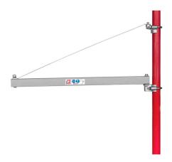
Der Schwenkarm für ESZ von Holzmann, Modell SA600750, bietet eine Ausladung von 750 mm und eine maximale Traglast von 600 kg. Der Schwenkbereich beträgt  $\pm 90^{\circ}$ . Das Eigengewicht des Schwenkarms beträgt 6 kg. Es ist wichtig zu beachten, dass der Schwenkarm ohne Mast geliefert wird und daher eine separate Mastdimension von Ø48 mm mit einer Mindestwandstärke von 3 mm erforderlich ist.
