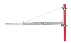
Der Schwenkarm für ESZ von Holzmann hat ein Eigengewicht von 6 kg und einen Schwenkbereich von  $\pm 90^{\circ}$ . Die Ausladung beträgt 750/1100 mm mit einer maximalen Tragfähigkeit von 600/300 kg (L2/L1). Ohne Mast.
