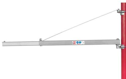
Der Schwenkarm für ESZ von Holzmann hat ein Eigengewicht von 6 kg und einen Schwenkbereich von  $\pm 90^\circ$ . Die Ausladung beträgt 750/1100 mm mit einer maximalen Tragfähigkeit von 600/300 kg (L2/L1). Ohne Mast.
