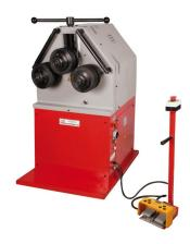
Die Holzmann RBM50\_400V Profi Rundbiegemaschine ist ideal zum Biegen von Profilen und Rohren geeignet. Durch die oben liegende Zustellvorrichtung mit Noniusskala kann der Biegeradius eingestellt werden. Mittels Universalrollen können viele unterschiedliche Profilgeometrien gebogen werden. Die Maschine verfügt über ein sehr hohes Eigengewicht für optimale Standsicherheit und geschliffene sowie gehärtete Richtrollen seitlich.
