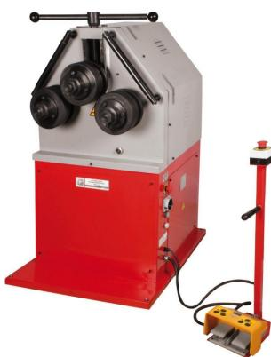
Die Holzmann RBM50\_400V Profi Rundbiegemaschine ist ideal zum Biegen von Profilen und Rohren geeignet. Durch die oben liegende Zustellvorrichtung mit Noniusskala kann der Biegeradius eingestellt werden. Mittels Universalrollen können viele unterschiedliche Profilgeometrien gebogen werden. Die Maschine verfügt über ein sehr hohes Eigengewicht für optimale Standsicherheit und geschliffene sowie gehärtete Richtrollen seitlich.
