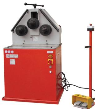
Die Holzmann RBM40K\_400V Profi Rohrbiegemaschine ist zum Biegen von Profilen und Rohren geeignet. Mittels Universalrollen können viele unterschiedliche Profilgeometrien gebogen werden. Die Maschine verfügt über eine oben liegende Zustellvorrichtung mit Noniusskala, um den Biegeradius einzustellen. Die Fußbedienung ermöglicht einen links-rechts Lauf. Die Biegewalzen sind aus widerstandsfähigem und gehärtetem Stahl gefertigt.
