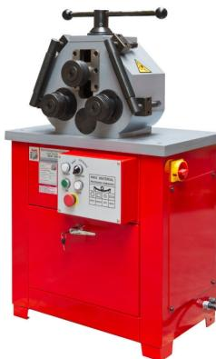
Die Holzmann RBM30\_400V Profi Rohrbiegemaschine ist zum Biegen von Profilen und Rohren geeignet. Durch die oben liegende Zustellvorrichtung mit Noniusskala kann der Biegeradius eingestellt werden. Die Maschine verfügt über 6 unterschiedliche Einsätze, die im Lieferumfang inkludiert sind. Das sehr hohe Eigengewicht sorgt für optimale Standsicherheit. Die Biegelwalzen bestehen aus widerstandsfähigen Stahl.
