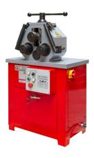
Die Holzmann RBM30\_400V Profi Rohrbiegemaschine ist zum Biegen von Profilen und Rohren geeignet. Durch die oben liegende Zustellvorrichtung mit Noniusskala kann der Biegeradius eingestellt werden. Die Maschine verfügt über 6 unterschiedliche Einsätze, die im Lieferumfang inkludiert sind. Das sehr hohe Eigengewicht sorgt für optimale Standsicherheit. Die Biegewalzen bestehen aus widerstandsfähigen Stahl.
