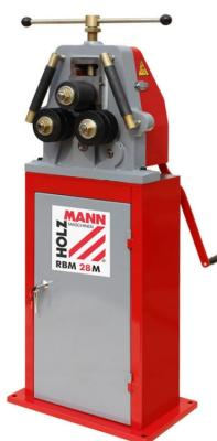
Die Holzmann RBM28M Ringbiegemaschine ist ideal zum Biegen von Vollmaterial und Profilen. Sie verfügt über Walzenwellen aus gehärtetem Spezialstahl und massive Gussräder. Die Maschine hat eine Wellen-Ø von 30 mm, eine Rollen-Ø oben von 98 mm und eine Rollen-Ø unten von 118 mm.
