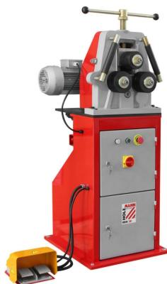
Die Holzmann RBM28\_400V Ringbiegemaschine ist zum Biegen von Vollmaterial und Profilen geeignet. Die motorische Ausführung und die Walzenwellen aus gehärtetem Spezialstahl garantieren eine hohe Präzision und Langlebigkeit. Die Maschine ist mit massiven Gussrädern und einer Wellen-Ø von 30 mm ausgestattet.
