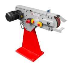
Die Holzmann MSM75\_400V Metallschleifmaschine bietet ein optimales Schleifergebnis durch hohe Bandgeschwindigkeit. Der einfache und schnelle Bandwechsel sowie das schwenkbare Schleifaggregat mit Schnellverstellung ermöglichen eine effiziente Arbeitsweise. Die Lauffläche mit Grafitbelag minimiert die Reibung und die Feineinstellung ermöglicht einen perfekten Bandlauf.
