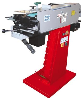
Die Holzmann MSM100PRO\_400V Metallschleifmaschine ist ein leistungsstarkes Gerät mit vielseitigen Einsatzmöglichkeiten. Es bietet eine Vorderseite für Rohr- und Profilschleifen, eine Oberseite für Planschleifen und eine Rücksseite für Entgratschleifen. Der Schleifwinkel kann zwischen 30 - 90° eingestellt werden, was hervorragende Schleifergebnisse durch die starke Einspannvorrichtung ermöglicht.
