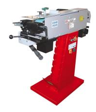
Die Holzmann MSM100PRO\_400V Metallschleifmaschine ist ein leistungsstarkes Gerät mit vielseitigen Einsatzmöglichkeiten. Es bietet eine Vorderseite für Rohr- und Profilschleifen, eine Oberseite für Planschleifen und eine Rücksseite für Entgratschleifen. Der Schleifwinkel kann zwischen 30 - 90° eingestellt werden, was hervorragende Schleifergebnisse durch die starke Einspannvorrichtung ermöglicht.
