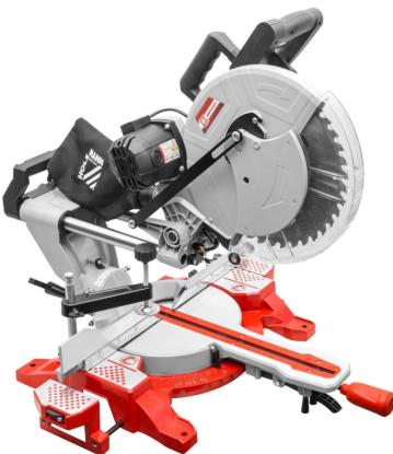
Die Holzmann KAP305ECO\_230V Zug- Kapp- & Gehrungssäge ist äußerst geräuscharm und mechanikschonend durch Riemenantrieb. Das Sägeaggregat ist links/rechts (-45°/°) schwenkbar und drehbar (-45°/°). Weitere Merkmale sind ein ausziehbarer Rückanschlag, ein schmaler Laserstrich, der exakt die Schnittlinie markiert, und ein besonders leichtgängiges und präzisionsgelagertes Doppelführungszugsystem. Das sehr massive Aludruckgussuntergestell gewährleistet optimale Standsicherheit.
