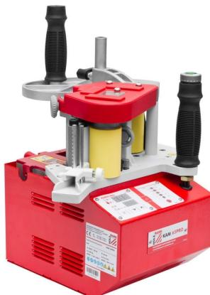
Das Holzmann KAM65PRO\_230V ist ein mobiles Kantenanleimgerät, ideal für den Montagegebrauch oder in Werkstätten. Es verfügt über ein Display zur Temperaturkontrolle und eine leicht zugängliche Schmelzwanne für einfaches Befüllen mit Klebegränulat. Die kurze Aufwärmzeit von 4 Minuten und der gleichmäßige Leimauftrag ermöglichen effizientes Arbeiten. Das Gerät ermöglicht das Vorleimen der Kanten für Eckverbindungen und bietet eine stufenlos regelbare Vorschubgeschwindigkeit.
