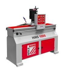
Die Holzmann HMS1000 400V Hobelmesserschleifmaschine ermöglicht das Schleifen gerader Klingen aus verschiedenen Winkeln, wie zum Beispiel Hobelmesser. Sie ist zum Schleifen von bis zu 4 Klingen gleichzeitig geeignet und prädestiniert für den Einsatz in der Möbelindustrie.
