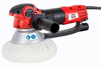
Der Holzmann EZS150PRO\_230V Profi Exzenterschleifer ist zum Schleifen und Polieren von Holz, Plastik, Metall, Stein und ähnlichen Materialien geeignet. Er bietet zwei Betriebsarten: Grobschliff und Feinschliff. Die Rotationsgeschwindigkeit ist über 6 Stufen regelbar. Der Schleifer verfügt über einen Sanftstart und einen weichen Gummigriff. Ein Absauganschluss mit 30 mm Durchmesser ermöglicht den Anschluss an eine Staubabsaugung.
