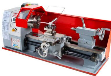
Die Holzmann ED400FD\_230V ist eine kompakte Tischdrehmaschine für die Bearbeitung von Stahl, Guss, NE-Metallen, Alu, Messing und Kunststoffen. Mit einer Spitzentfernung von 400 mm können mit ihr auch längere Werkstücke bearbeitet werden. Die Prismenbettführung ist induktiv gehärtet und präzisionsgeschliffen. Hohe Rundlaufgenauigkeit und hochwertige Bauweise ergeben eine kompakte und durchzugsstarke Drehbank für den ambitionierten Metallbearbeiter.
