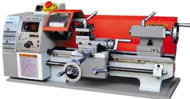
Die Holzmann ED300FD\_230V Metalldrehbank bietet variable Geschwindigkeit und ist ideal für Gewindeschneiden oder automatisches Längsdrehen. Das Gerät verfügt über prismafbettführungen, die induktiv gehärtet und präzisionsgeschliffen sind, sowie eine gehärtete Hauptspindel in nachstellbaren präzisen Kegelrollenlagern. Die Drehzahl ist stufenlos regelbar und kann komfortabel über eine digitale Drehzahlanzeige abgelesen werden.
